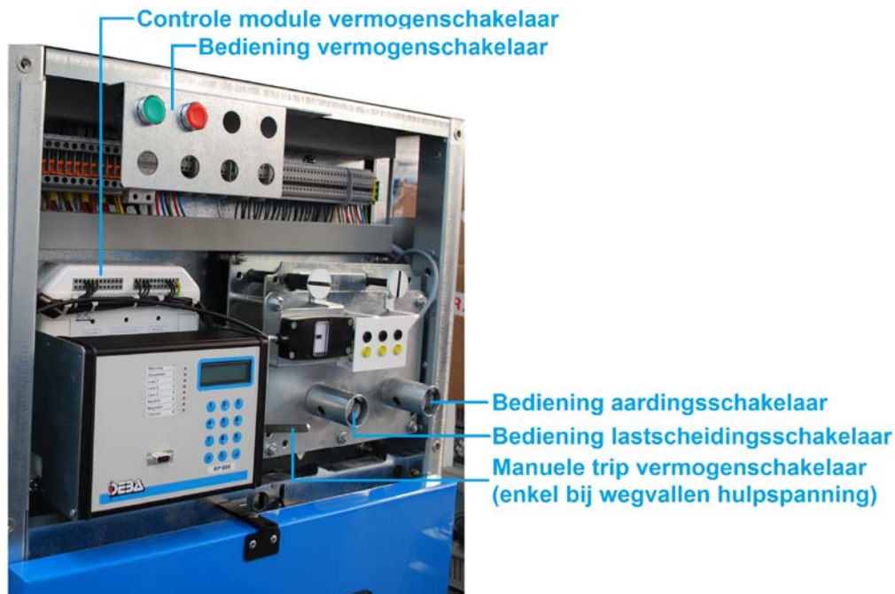
Figuur 5: Aandrijfmechanisme DF-DT(G)
