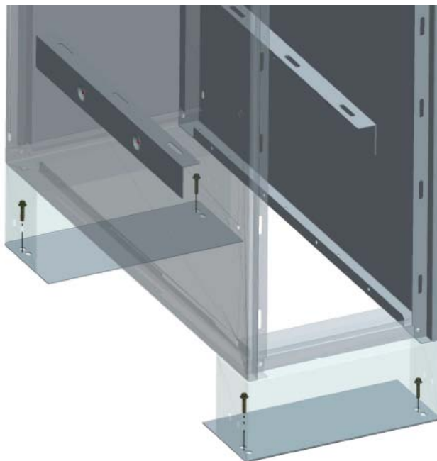
Figuur 7: Opstelling: Bevestiging DF-3 cel
